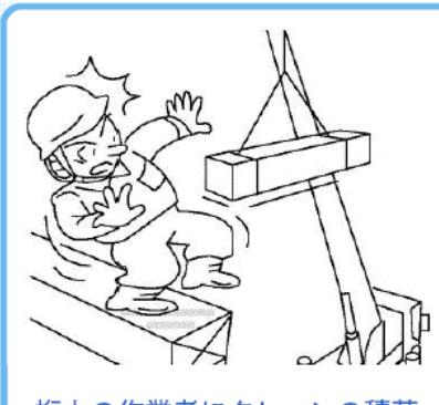
桁上の作業者にクレーンの積荷が接触しかかり、転落しそうになった
