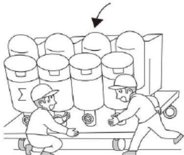
給水ポンプユニットの運搬中、台車の車輪の位置を変えようとしたところ、給水ポンプユニットが倒れて下敷きになりました。
