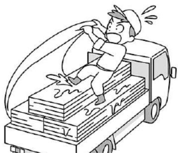
トラック荷台上で鋼材に掛けていたシートを剥がす作業中、雨で濡れた鋼材の上で足が滑り転倒しそうになった
