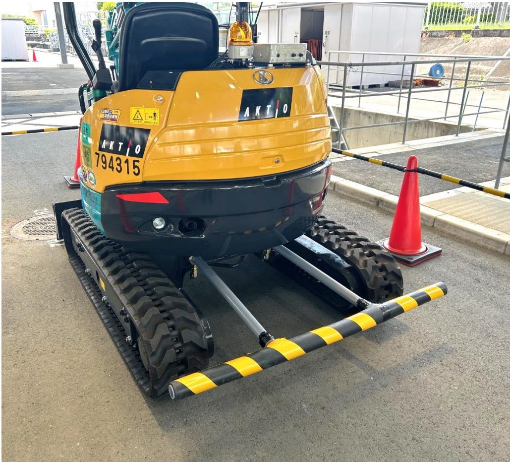
【塩ビ管で作る接触防止装置】
