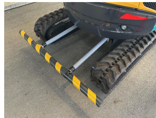
【塩ビ管で作る接触防止装置】
