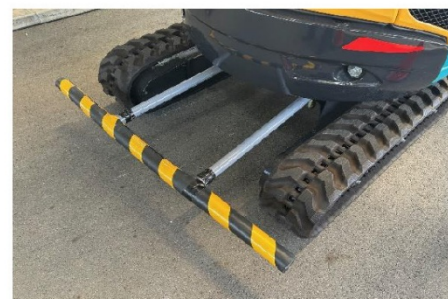
【塩ビ管で作る接触防止装置】
