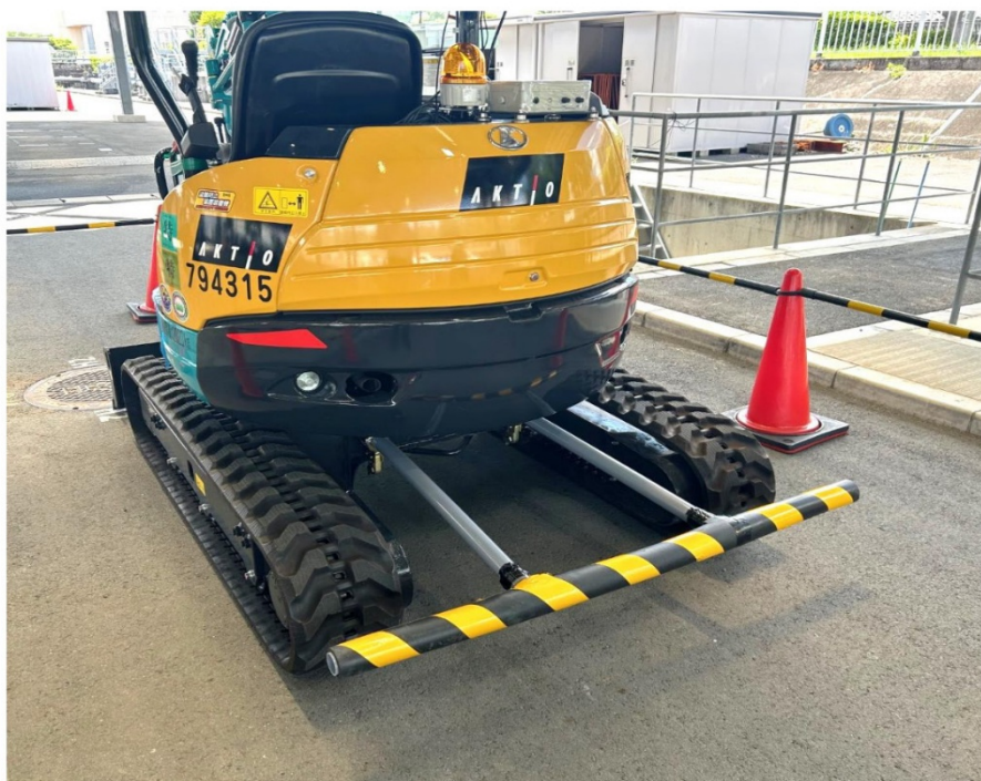
【塩ビ管で作る接触防止装置】
