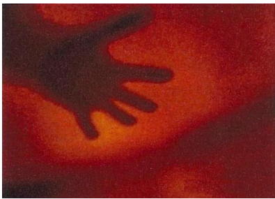
光の透過(槽内から外にかざした手の形がはっきりと確認できる)
