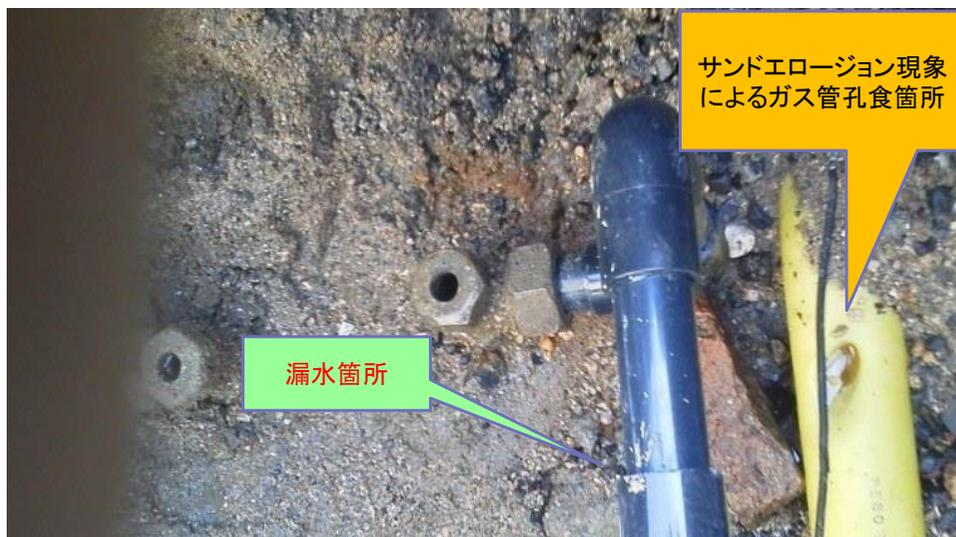
広島市でも過去にサンドエロージョン現象が発生し、ガス管を損傷する事故が起きています。
