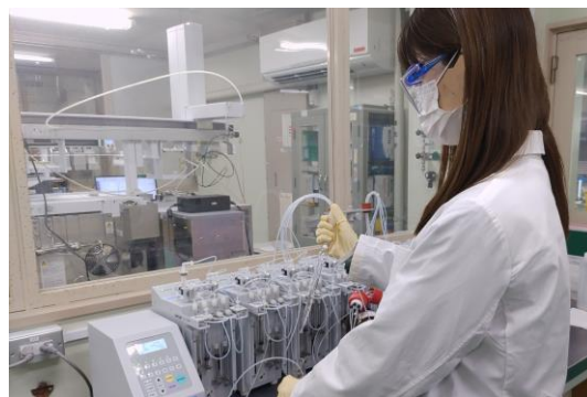
フェノール類の検査 (固相加圧送液装置による前処理)
