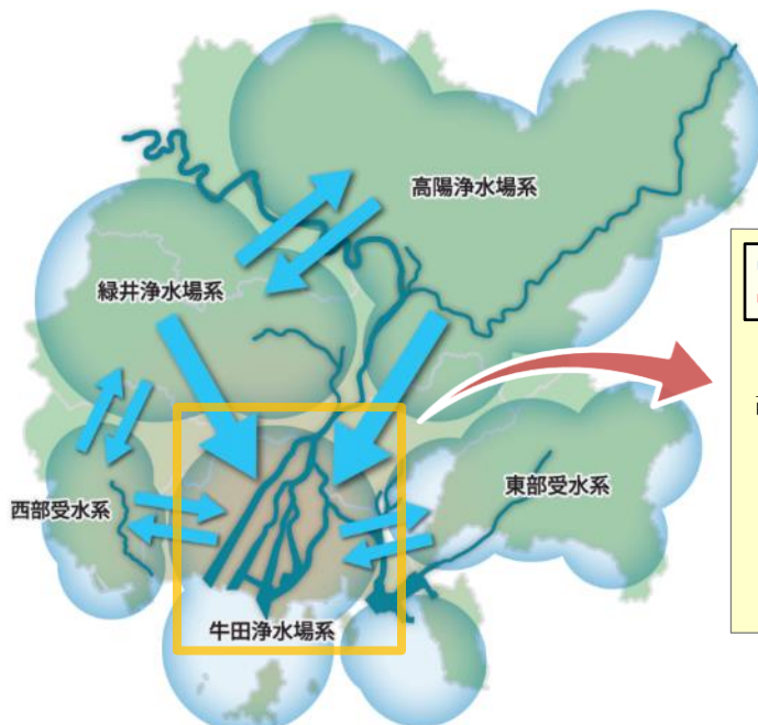
配水系統間のバックアップ体制
