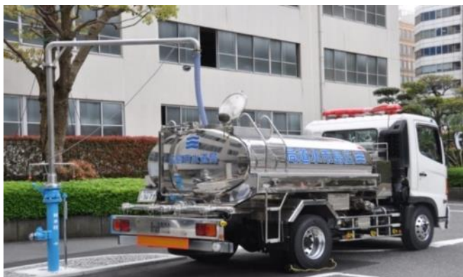
給水車 (3,800ℓ) と給水車用水栓柱
