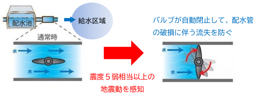
図 緊急遮断弁の仕組み
