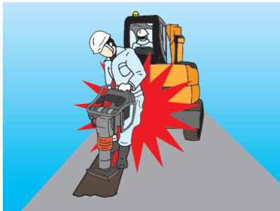
重機と作業員の接触
