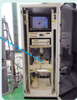
▲魚類自動監視装置
