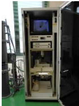
魚類自動監視装置
