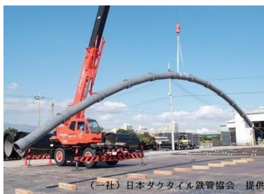
▲ 吊り下げても曲がって抜けない耐震継手管
