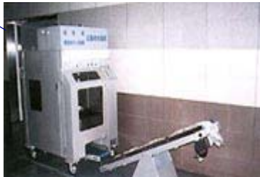
▲非常用飲料水バック装置
