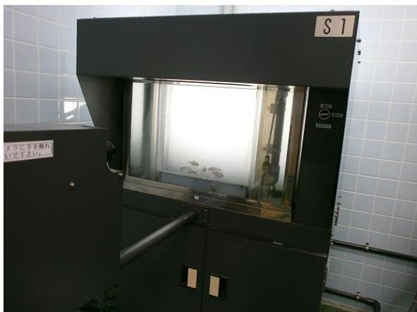
▲ 魚類自動監視装置での水質監視
