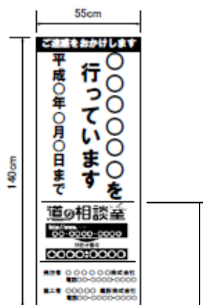
(様式4) 工事説明看板 (占用企業工事)
