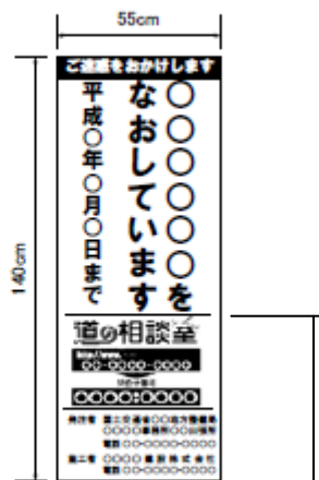
(様式2) 工事説明看板 (道路補修工事)
