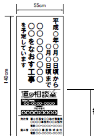
(様式1) 工事情報看板 (道路補修工事)
