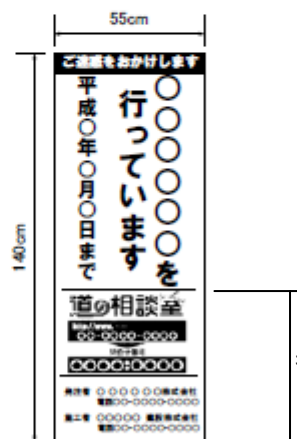
(様式4) 工事説明看板 (占用企業工事)
